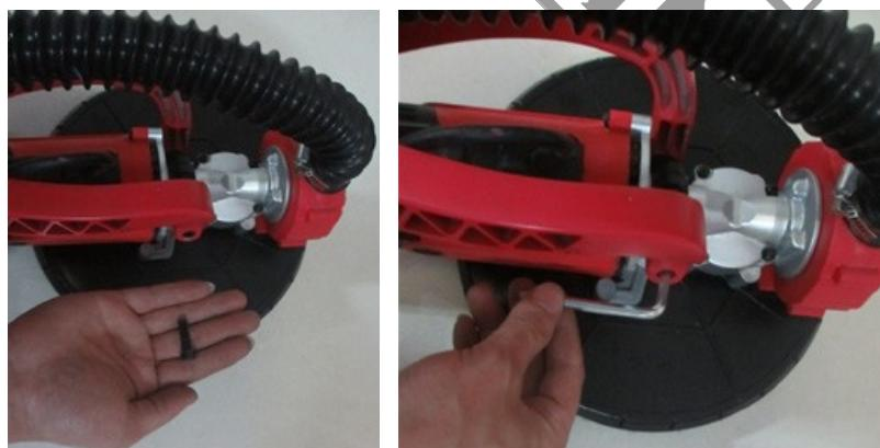
c. Installazione del tubo telescopico (inserire il tubo telescopico nel tubo anteriore, regolare alla lunghezza adatta, girare il dado di bloccaggio nel tubo anteriore in plastica e bloccare).
