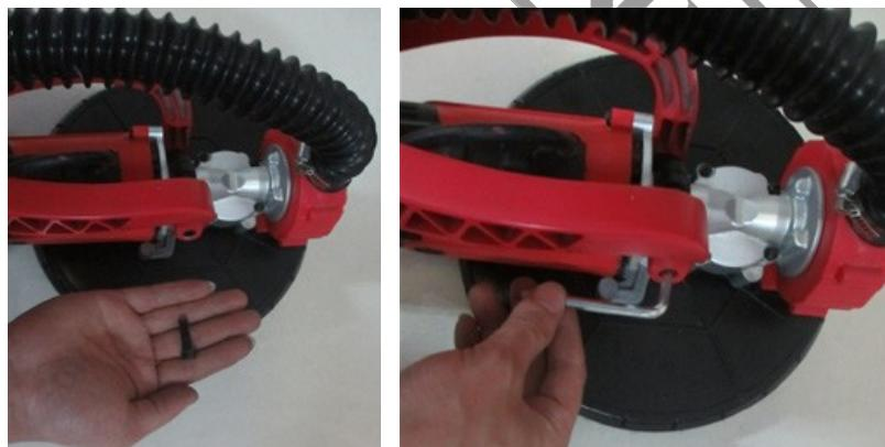
c. Instalarea țevii telescopică (introduceți țeava telescopică în țeava frontală, reglați-o la lungimea potrivită, roțiți piulița de blocare în țeava de plastic frontală și blocați-o.)
