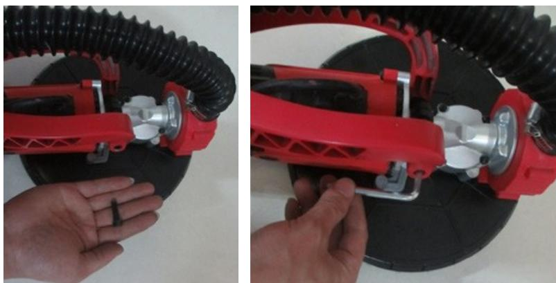
с. Монтаж на телескопичната тръба (поставете телескопичната тръба в предната тръба, регулирайте до подходяща дължина, завъртете заключващата гайка в предната пластмасова тръба и застопорете.)
