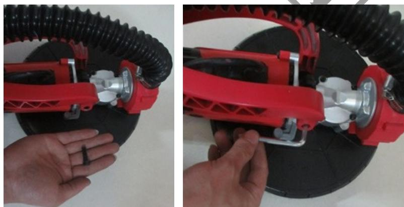
c. Installation du tuyau télescopique (insérer le tuyau télescopique dans le tuyau avant, l'ajuster à la longueur appropriée, tourner l'écrou de verrouillage dans le tuyau avant en plastique et le verrouiller).
